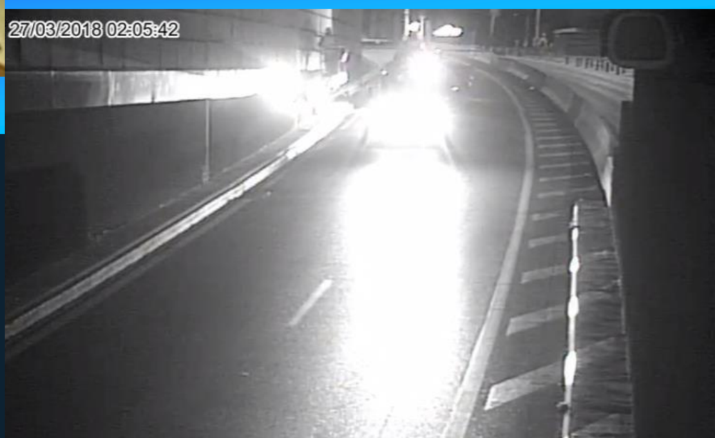
Inaccurate « Wrong way » alarm
